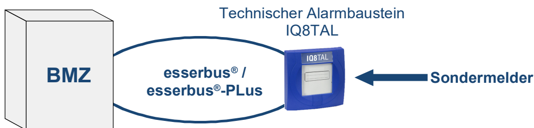
Abb. 6: Prinzipanschaltung Technischer Alarmaustein IQ8TAL
